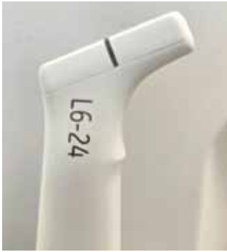
Рис. 1. Высокочастотный датчик 24 МГц Г-образной формы (источник: составлено авторами)
