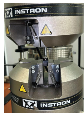
Рис. 9. Модель с образцом фиксирована в испытательной машине
