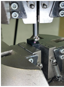
Рис. 10. Проведение динамической нагрузки на сжатие (источник: составлено авторами)
