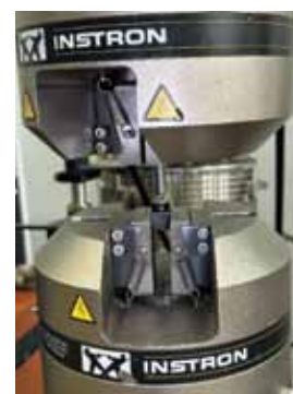
Рис. 9. Модель с образцом фиксирована в испытательной машине (источник: составлено авторами)
