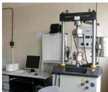
Рис. 8. Испытательная сервогидравлическая машина (источник: составлено авторами)
