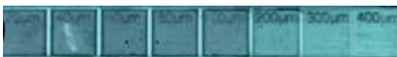
Рис. 3. Силиконовая пленка-индикатор из анализатора для количественного контроля посадки: эталонные секции толщиной 20, 40, 60, 80, 100, 200, 300 и 400 мкм (источник: составлено авторами)
