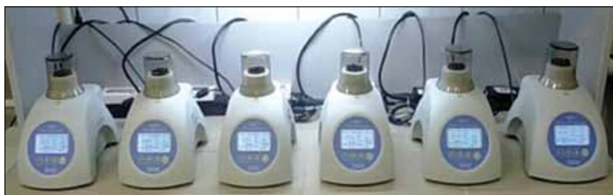
Рис. 1. Система автоматизированного культивирования микроорганизмов «Реверс-Спиннер RTS-1» (BioSan, Латвия)
