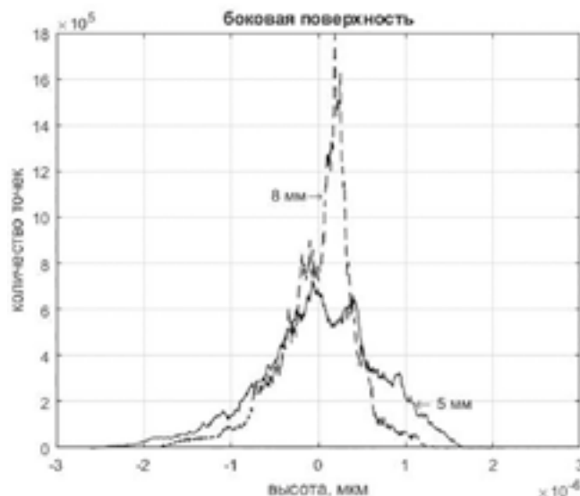
Рис. 8. Функция распределения точек по высоте для сканированной эмали контактной поверхности резца
