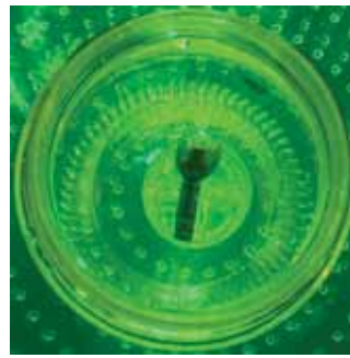
Рис. 21. Утечка красителя у образца 2 не наблюдается (источник: составлено авторами) Fig. 21. Absence of dye leakage in sample 2 (Sources: compiled by the author)
