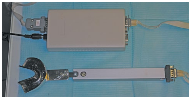
Рис. 6. Устройство и многоканальный цифровой измерительный прибор для определения степени ретенции и стабилизации съемного протеза
