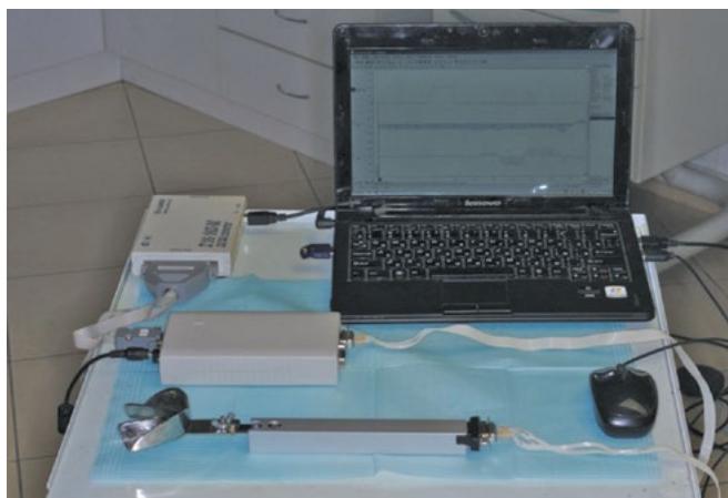
Рис. 6. Устройство и многоканальный цифровой измерительный прибор для определения степени ретенции и стабилизации съемного протеза
